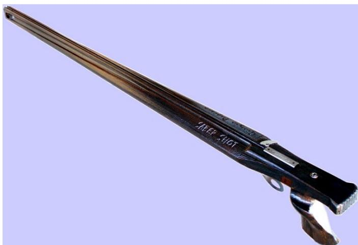
L'evoluzione dei primi arbalètes in quelli di seconda generazione era dovuta principalmente a ragioni tecniche: gli studi balistici culminati nel 2004 con le prime prove in vasca, filmate usando videocamere ad alta velocità, avevano dimostrato che, nei modelli tradizionali, per lanciare un'asta da 7 mm di diametro (che dimostrava avere una balistica migliore rispetto le aste più fini) non bastava più un solo elastico, ma bisognava aumentare il numero dei propulsori.
